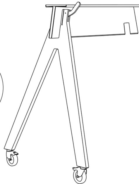
**SCHRITT 3:** Stecke das zweite Bein leicht schräg, parallel zum Schlitz ein. Achte darauf, dass der Hebel nach oben und der schwarze Winkel nach innen zeigt.
