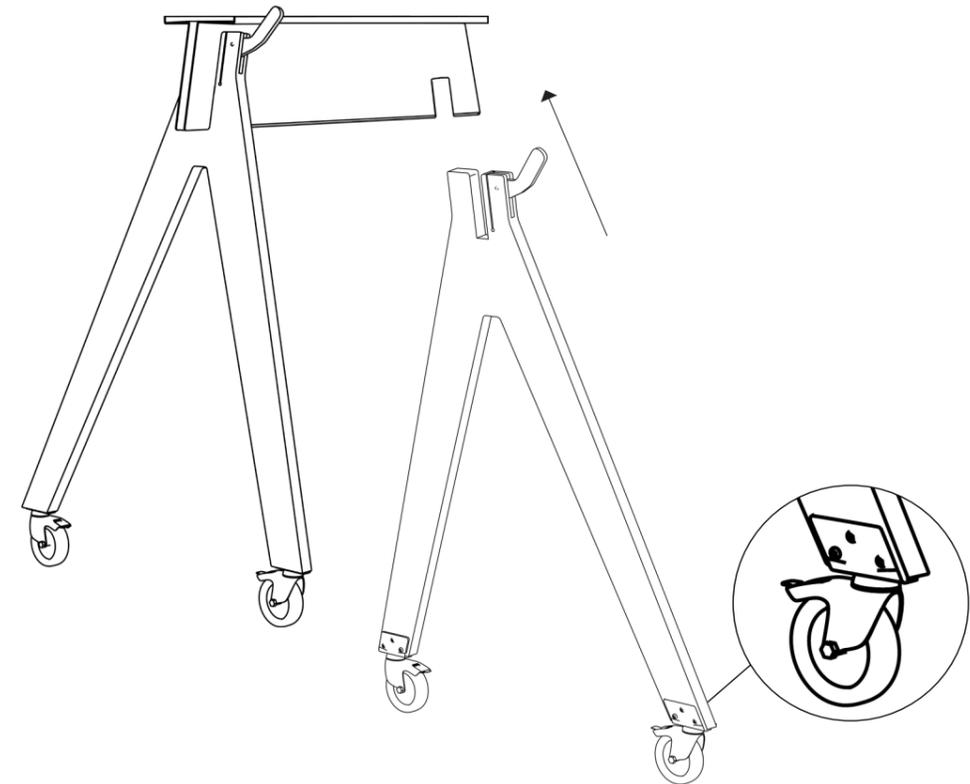
Zur einfacheren Montage kannst du das Gestell nach Schritt zwei auch auf einen weichen Untergrund legen und kopfüber das Bein montieren.
